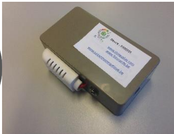
Figure 94 – Outil de mesure de la qualité de l'air développé par Futurocité et Thingsplay (capteur et label)
